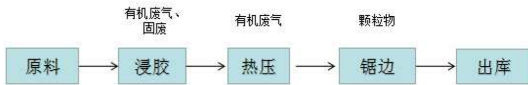
图 4-22 生产工艺流程图
